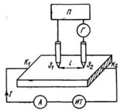
ИТ – источник тока, A – амперметр, Г – гальванометр, П – потенциометр, 31, 32 – зонды, К1, К2 – торцевые контакты.
