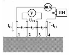
, где ИН – источник напряжения, mA – миллиамперметр, V – вольтметр, I14 – сила тока в цепи (через зонды 1 и 4), U23 – разность потенциалов между зондами 2 и 3, S1=S2=S3 – расстояние между зондами. Рабочая формула четырехзондового метода для полубесконечного образца, в случае, когда расстояния между зондами S1=S2=S3 равны:
